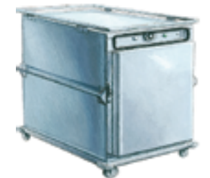
10024 Etuve électrique ventilée 16 grilles Electrique 220 V / 16A monophasé - 3,6 kW. 1 prise. Température maxi : 200°C en 90 min. Livrée avec 16 grilles pâtisseries. Ext. : L 79 ; l 125 ; H 130 cm. Int. : L 60 ; l 80 ; H 85 cm. 217 Kg
