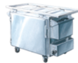
11527 Etuve électrique petit modèle 220/230 V - 16 A monophasé - 2 kW Température maxi 150°C en 30 min - Combiné adaptable pâtisserie ou gastronomie 1/1. Fourni avec 5 grilles pâtisseries 60 x 40 cm. Espace entre les grilles : 7 cm. Ext. : L 89 ; P 50,5 ; H 73 cm. Int. : L 60 ; P 40 ; H 45,5 cm
