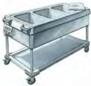
0395 Bain-marie électrique 220 V / 16A monophasé - 2,5 kW. Temps de chauffe à sec : 30 min. Commande indépendante des compartiments. Thermostat réglable de 30°C à 95°C. Livré avec 3 bacs gn 1/1. Ext. : L 122 ; l 70 ; H 90 cm. 55 Kg
