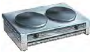
0373 Crêpière double électrique 2 alimentations de 220 V / 16A - 5 kW ou une bouteille de gaz fournie (détendeur 28 Mb). 2 plaques Ø 35 cm. Râteau à crêpes fourni avec la crêpière. L 86 ; l 46 ; H 22 cm. 35 Kg
