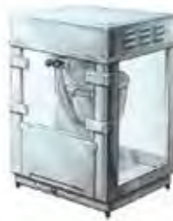
0379 Machine à pop-corn 220 V / 16A monophasé - 1,6 kW. Chauffe contrôlée par thermostat. Livrée avec une pelle à pop-corn Ext. : L 47 ; l 43 ; H 78 cm. 44 Kg En complément : cornets à pop-corn page 88
