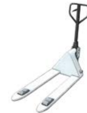
1102 Transpalette L 155 ; I 53 cm. Hauteur du bras de traction : 123 cm. Support bras de levage : 2 roues caoutchouc. Support de fourches : 4 roues nylon. Capacité de levage : 2 t. 65 Kg
