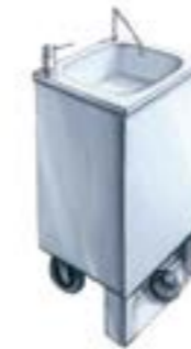
9500 Evier lave-mains autonome Livré avec 1 bidon de réserve d'eau (20 L), 1 bidon pour récupérer l'eau usée (20 L), 1 bidon de savon (15 cl). Ext. : L 42 ; I 36 ; H 100 cm. 20 Kg
