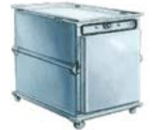
10024 Etuve électrique ventilée 16 grilles Electrique 220 V / 16A monophasé - 3,6 kW. 1 prise. Température maxi : 200°C en 90 min. Livrée avec 16 grilles pâtisseries. Ext. : L 79 ; I 125 ; H 130 cm. Int. : L 60 ; I 80 ; H 85 cm. 217 Kg
