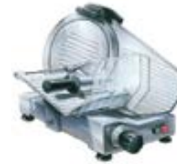
13341 Trancheur à jambon professionnel 220 V - 370 W / 16 A. Ext : L 62 ; P 72 ; H 53 cm. Lame de coupe Ø 35 cm. 36 Kg
