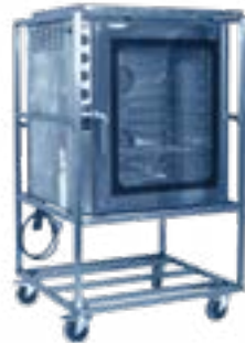
27081 Four mixte à vapeur électrique 12,6 kw. Four 10 niveaux Raccordement à l'eau ou autonome (5 L) 11,5 Kg - Espace entre les grilles 7,4 cm Int.: l 85 x P 65 cm H 96 cm Ext.: l 95 x P 87 cm H 162 cm
