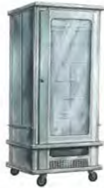
445 Armoire réfrigérée ventilée 400 L 220 V / 16A monophasé - 320W. + 1 à + 4° C. Livrée avec 5 grilles gn 2/1 (65 x 53 cm). Ext. : L 76 ; l 94 ; H 186 cm. Int. : L 56 ; l 67 ; H 115 cm. 146 Kg
