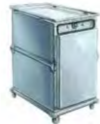
9938 Étuve électrique ventilée 8 grilles Electrique 220 V / 16A monophasé 3 kW. 1 prise. Température maxi : 250°C en 60 min. Livrée avec 8 grilles pâtisseries 60 x 40 cm. Espace entre les grilles : 7 cm. Ext. : L 65 ; l 105 ; H 132 cm. Int. : L 40,5 x l 60 x H 85,5 cm 150 Kg
