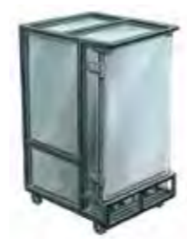
409 / 229 Étuve morice mixte Livrée avec 8 grilles. Espace entre les grilles : 8 cm. Ext. : L 74 ; l 96 ; H 135 cm. Int. : L 60 ; l 80 ; H 95 cm. 143 Kg Gaz (229) : 1 bouteille de gaz butane (20 Kg). Détendeur de 28 mbar. Équipée d'une sonde thermostatique pour le gaz, les rampes se coupent à 180°C et se rallument à 160°C. Electrique (409) : 220 V / 16A monophasé - 4,5 kW. Répartis entre 2 prises (1,5 kW et 3 kW)
