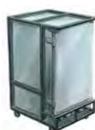
409 / 229 Étuve morice mixte Livrée avec 8 grilles. Espace entre les grilles : 8 cm. Ext. : L 74 ; l 96 ; H 135 cm. Int. : L 60 ; l 80 ; H 95 cm. 143 Kg Gaz (229) : 1 bouteille de gaz butane (20 Kg). Détendeur de 28 mbar. Équipée d'une sonde thermostatique pour le gaz, les rampes se coupent à 180°C et se rallument à 160°C. Electrique (409) : 220 V / 16A monophasé - 4,5 kW. Répartis entre 2 prises (1,5 kW et 3 kW)
