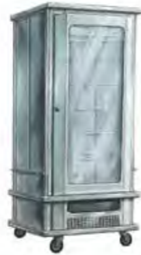
445 Armoire réfrigérée ventilée 400 L 220 V / 16A monophasé - 320W. + 1 à + 4° C. Livrée avec 5 grilles gn 2/1 (65 x 53 cm). Ext. : L 76 ; I 94 ; H 186 cm. Int. : L 56 ; I 67 ; H 115 cm. 146 Kg
