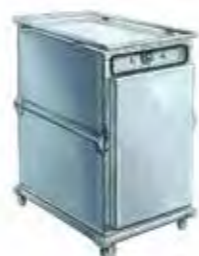
9938 Étuve électrique ventilée 8 grilles Electrique 220 V / 16A monophasé 3 kW. 1 prise. Température maxi : 250°C en 60 min. Livrée avec 8 grilles pâtisseries 60 x 40 cm. Espace entre les grilles : 7 cm. Ext. : L 65 ; l 105 ; H 132 cm. Int. : L 40,5 x l 60 x H 85,5 cm 150 Kg
