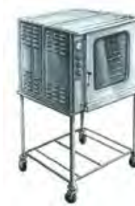
397 Four ventilé humidifié 380 V / 32A triphasé + neutre 16 kW - Prise P 17. Réservoir d'eau autonome, capacité 3 L. Réglage du thermostat de 50 à 270°C. Fourni avec 10 grilles gn 1/1 (53 x 32,5 cm). Espace entre les grilles : 6 cm. Ext. : L 96 ; I 108 ; H 165 cm. Int. : L 69 ; I 41 ; H 53 cm. 180 Kg
