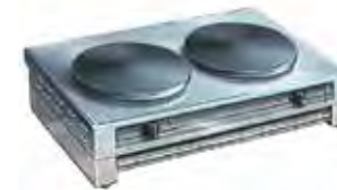
373 Crêpière double électrique 2 alimentations de 220 V / 16A - 5 kW ou une bouteille de gaz fournie (détendeur 28 Mb). 2 plaques Ø 35 cm. Râteau à crêpes fourni avec la crêpière. L 86 ; l 46 ; H 22 cm. 35 Kg
