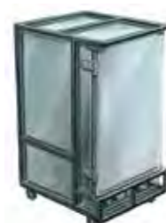
0409 / 0229 Étuve morice mixte Livrée avec 8 grilles. Espace entre les grilles : 8 cm. Ext. : L 74 ; I 96 ; H 135 cm. Int. : L 60 ; I 80 ; H 95 cm. 143 Kg Gaz (0229) : 1 bouteille de gaz butane (20 Kg). Détendeur de 28 mbar. Équipée d'une sonde thermostatique pour le gaz, les rampes se coupent à 180°C et se rallument à 160°C. Electrique (0409) : 220 V / 16A monophasé - 4,5 kW. Répartis entre 2 prises (1,5 kW et 3 kW)
