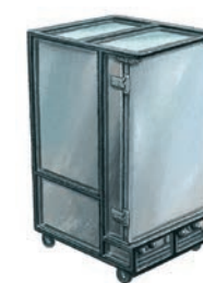
0409 / 0229 Etuve morice mixte Livrée avec 8 grilles. Espace entre les grilles : 8 cm. Ext. : L 74 ; l 96 ; H 135 cm. Int. : L 60 ; l 80 ; H 95 cm. 143 Kg Gaz (0229) : 1 bouteille de gaz butane (20 Kg). Détendeur de 28 mbar. Équipée d'une sonde thermostatique pour le gaz, les rampes se coupent à 180°C et se rallument à 160°C. Electrique (0409) : 220 V / 16A monophasé - 4,5 kW. Répartis entre 2 prises (1,5 kW et 3 kW)
