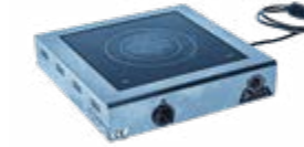
389 Réchaud vitrocéramique 220 V / 16A monophasé - 2,1 kW. Feu Ø 30 cm. 1 bouton de réglage Ext. : L 42 I 42 H 10 cm. 8 Kg. De 50 à 270°C.
