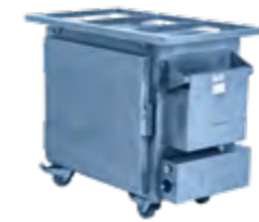
11527 Étuve électrique petit modèle 220/230 V - 16 A monophasé - 2 kW Température maxi 150°C en 30 min - Combiné adaptable pâtisserie ou gastronomique 1/1. Fourni avec 5 grilles pâtisseries 60 x 40 cm. Espace entre les grilles : 7 cm. Ext. : L 89 P 50,5 H 73 cm. Int. : L 60 P 40 H 45,5 cm
