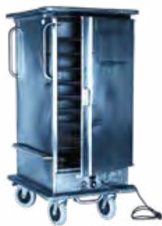
411 Étuve ventilée humidifiée 8 grilles 220 V / 16A monophasé - 2,2 kW. Température maxi : 150°C en 50 min. Livrée avec 8 grilles gn 2/1 (65 x 53 cm). Espace entre les grilles : 10,5 cm. Bloc de ventilation surmonté d'un bac gn 2/1 et d'un Z antivague. Ext. : L 77 l 93 H 162 cm. 135 Kg
