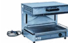
791 Salamandre 220 V / 4,5 kW répartis en 2 prises de 2,25 kW. 10013 380 V / 32A triphasé prise P 17. 1 grille. Ext. : L 80 ; P 45 ; H 54 cm. Int. : L 59 ; P 35 ; H 26 cm. 27 Kg
