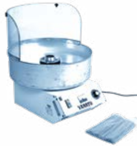
375 Machine à barbe à papa 220 V / 16A - 2 kW. Ext. : L 60 ; P 66 ; H 41 cm et 70 cm avec la protection. Bassine Ø 58 cm. Mise en route 15 secondes. Livrée avec 200 bâtonnets. Colorant sur demande. 43 Kg (photo non contractuelle)
