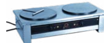
373 Crêpière double électrique 2 alimentations de 220 V / 16A - 5 kW ou une bouteille de gaz fournie (détendeur 28 Mb). 2 plaques Ø 35 cm. Râteau à crêpes fourni avec la crêpière. L 86 ; l 46 ; H 22 cm. 35 Kg
