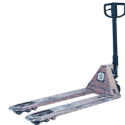
1102 Transpalette L 155 ; l 53 cm. Hauteur du bras de traction : 123 cm. Support bras de levage : 2 roues caoutchouc. Support de fourches : 4 roues nylon. Capacité de levage : 2 t. 65 Kg
