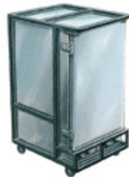
0409 / 0229 Etuve morice mixte Livrée avec 8 grilles. Espace entre les grilles : 8 cm. Ext. : L 74 ; l 96 ; H 135 cm. Int. : L 60 ; l 80 ; H 95 cm. 143 Kg Gaz (0229) : 1 bouteille de gaz butane (20 Kg). Détendeur de 28 mbar. Équipée d'une sonde thermostatique pour le gaz, les rampes se coupent à 180°C et se rallument à 160°C. Electrique (0409) : 220 V / 16A monophasé - 4,5 kW. Répartis entre 2 prises (1,5 kW et 3 kW)
