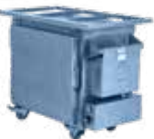
11527 Etuve électrique ventilée petit modèle 220/230 V - 16 A monophasé - 2 kW Température maxi 150°C en 30 min - Combiné adaptable pâtissière ou gastronorme 1/1. Fourni avec 5 grilles pâtisseries 60 x 40 cm. Espace entre les grilles : 7 cm. Ext. : L 89 ; P 50,5 ; H 73 cm. Int. : L 60 ; P 40 ; H 45,5 cm
