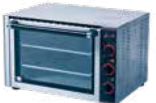
474 Four professionnel électrique petit modèle 220 V - 2,5 kW. Régulation thermostatique de 0° à 250°. Minuterie. Livré avec une grille et une plaque. Ext. : L 60 ; l 45 ; H 35 cm. Int. : L 33 ; l 35 ; H 27 cm. 30 Kg
