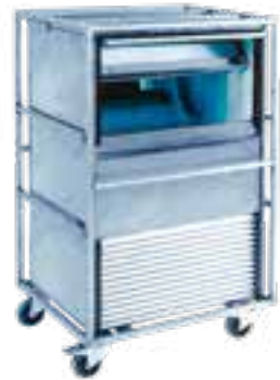
27089 Machine à glaçons Int. : L 67 x P 56 cm H 98 cm Ext. : L 72 x P 66 cm H 116 cm Porte glissant vers l'intérieur - 775W 30 mn de mise en marche et refroidissement Cycle de 15 mn = 55 glaçons Production de 75 Kg /24h Stockage 37 Kg - Poids 60 Kg En complément : pelle à glaçons page 319
