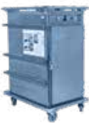
9938 Etuve électrique ventilée 8 grilles Electrique 220 V / 16A monophasé 3 kW. 1 prise. Température maxi : 250°C en 60 min. Livrée avec 8 grilles pâtisseries 60 x 40 cm. Espace entre les grilles : 7 cm. Ext. : L 65 ; l 105 ; H 132 cm. Int. : L 40,5 x l 60 x H 85,5 cm 150 Kg
