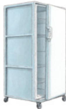
684 Réfrigérateur 500 litres 220 V / 16 A monophasé 150 W. Livré avec 5 grilles 68 x 52 cm. Ext. : L 80 ; l 80 ; H 180 cm. 95 Kg
