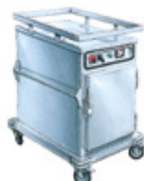
10823 Four ventilé 6 niveaux gastro 220 V Electrique 220 V / 16 A monophasé - 3,5 kW. Régulation thermostatique 0 à 300°C. Ventilation intégrée. Livré avec 6 grilles gn. Ext. : L 58 ; l 93 ; H 94 cm. 103 Kg
