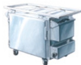
11527 Étuve électrique petit modèle 220/230 V - 16 A monophasé - 2 kW Température maxi 150°C en 30 min - Combiné adaptable pâtisseries ou gastronomie 1/1. Fourni avec 5 grilles pâtisseries 60 x 40 cm. Espace entre les grilles : 7 cm. Ext. : L 89 ; P 50,5 ; H 73 cm. Int. : L 60 ; P 40 ; H 45,5 cm
